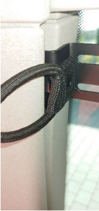
Foto: Optimaler Sitz des oberen Winkels. Winkel wurde mit etwas Druck gegen die Fahrzeugverkleidung montiert. Die Gummipuffer verhindern ein Scheuern des Metalls an der Innenverkleidung.
