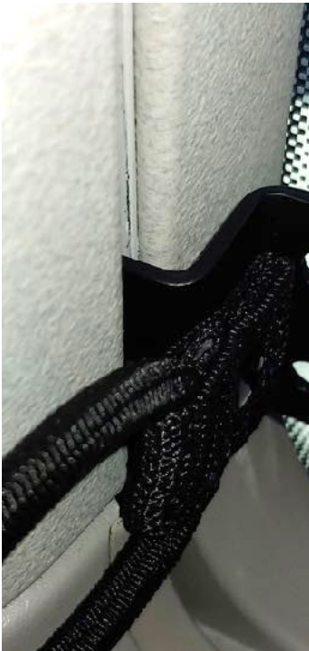
Foto: Unterer Winkel in Richtung Heck des Fahrzeugs. Dieser hat im oberen Bereich etwas Abstand zur Fahrzeugverkleidung. Dies hängt mit der Rundung der Kunststoffverkleidung zusammen.
