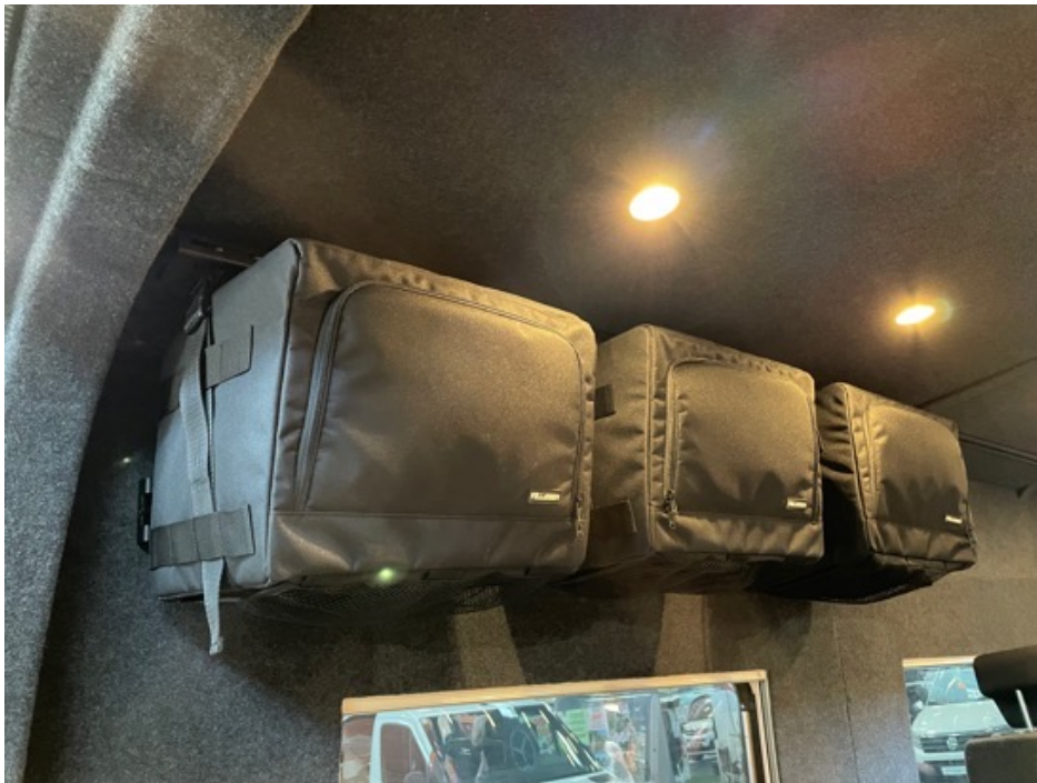
VW Crafter von MultiCamper. Drei Roofbags mit sechs Einzelhalter an einer Airlineschienen
